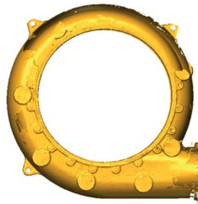
Рис. 2. Облако точек, которое получается после сканирования
